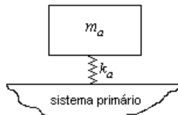
Figura 2.1 – Neutralizador dinâmico massa-mola.
