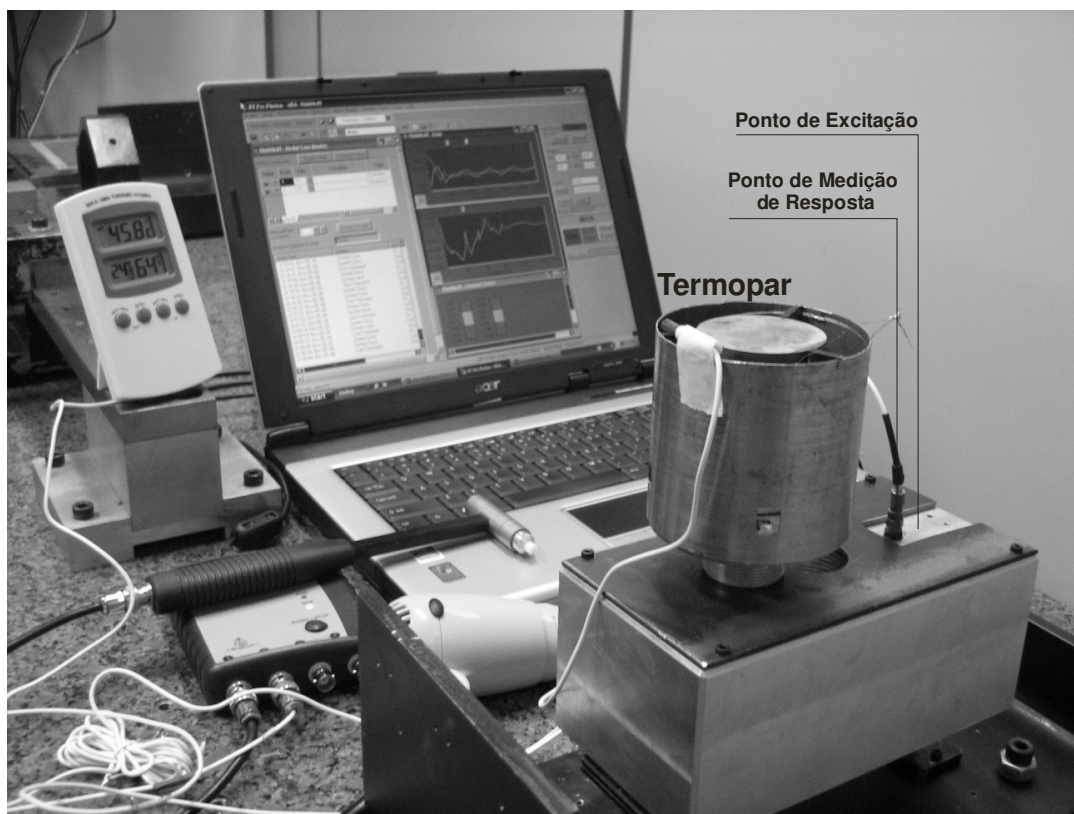
Figura 5.7 – Sistema primário e NDHEV: esquema de medição.
